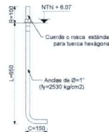
DETALLE 3. ANCLAJES ELEVACIÓN ESCALA: S/E acot: mm
